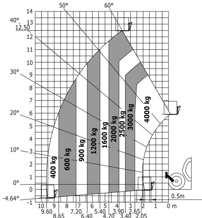
Rotación sobre estabilizadores bajados, con horquillas
